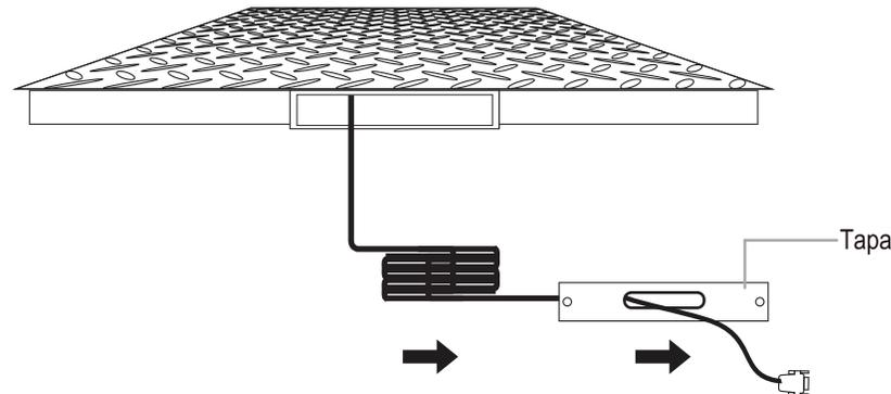
3. Finalmente coloque la tapa de la plataforma nuevamente en su lugar y atorníllela. Ya puede utilizar su plataforma y conectarla a un indicador electrónico.
