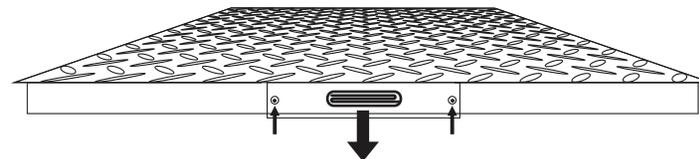
2. Una vez afuera el cable debe desenrollarlo, posteriormente debe pasar el conector a través del orificio de la tapa.
