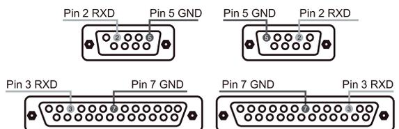
**NOTA.** Asegúrese que el pin TXD del indicador se encuentre conectado con el pin RXD de la impresora.
